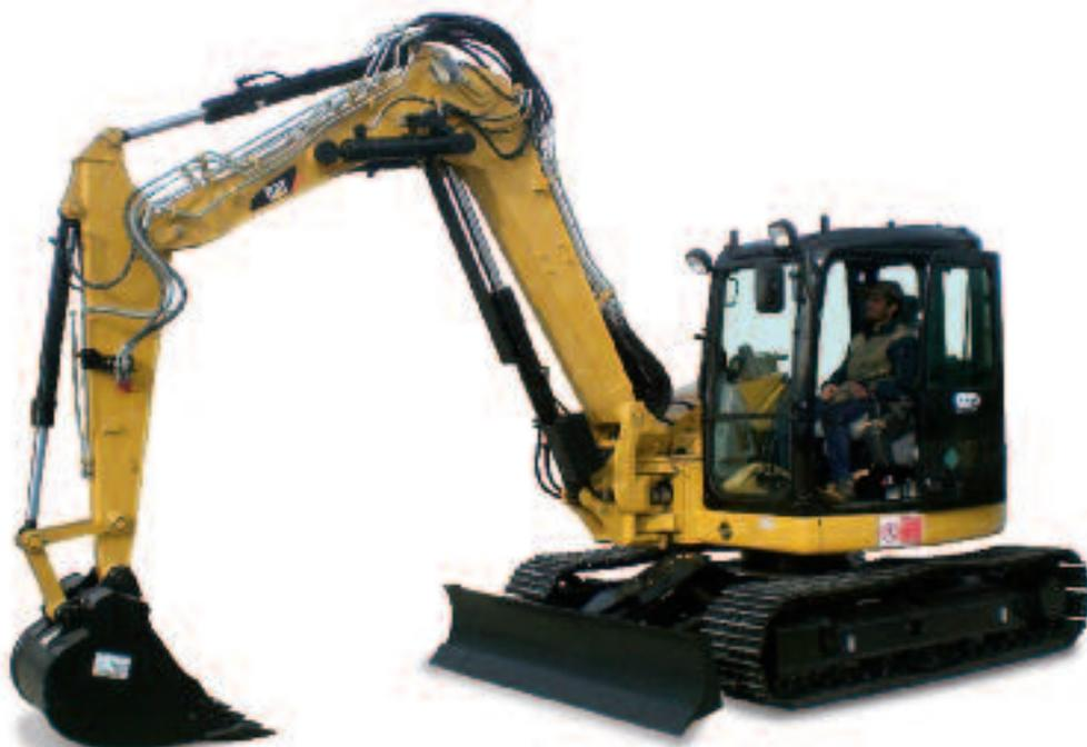
L'escavatore 308D CR SB con braccio a geometria variabile offre un raggio di lavoro più esteso per facilitare le operazioni di livellamento. Consente inoltre di scavare vicino alla macchina, eliminando il bisogno di riposizionare il carro.
